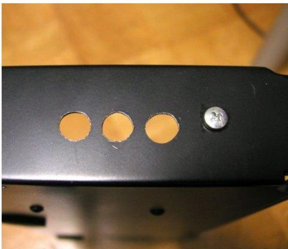
2. ケース底面に基板止めの穴を 2 (または 3) 個開ける
