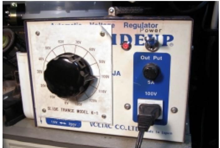
写真4 ヒータ電圧調整用スライダック
