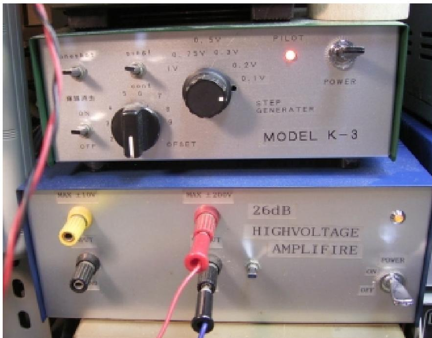
写真5 ステップジェネレータと、グリッド電圧増幅用高電圧アンプ
