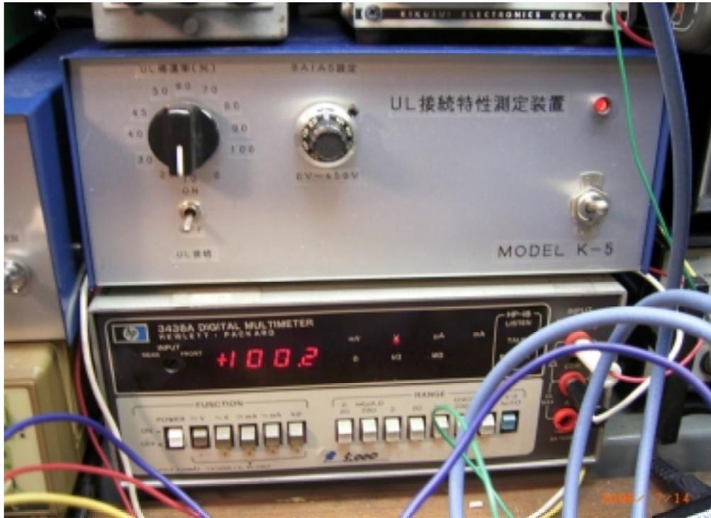
写真6 S<sub>g</sub>電圧供給用電源（UL特性も測定可）と、S<sub>g</sub>電圧監視用電圧計
