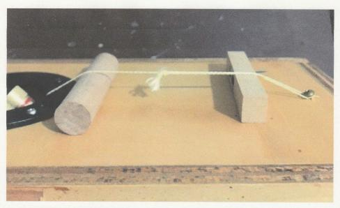
張力を調整するときに画像のように棒をリアバッフルとケブラーケーブルの間に挟みます。
