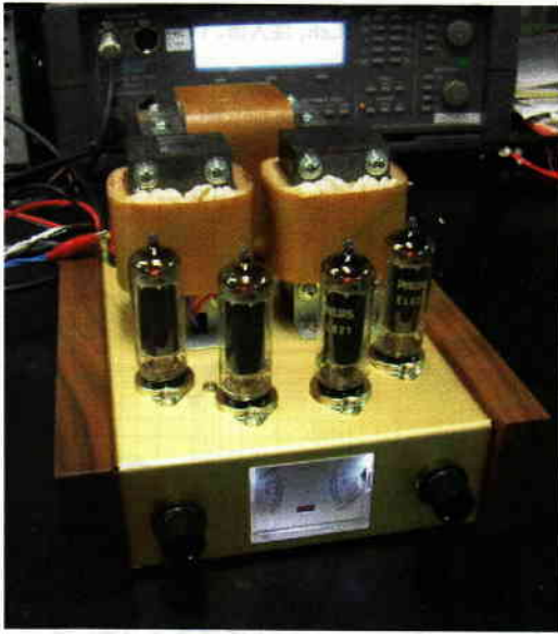
きわめてシンプル、かつ高性能な歪打消し回路 (ラジオ技術誌2008年5月号より引用)
