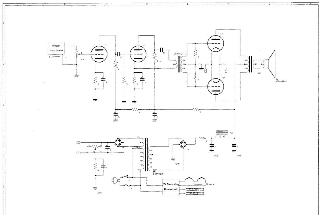
現在初段と第二段は76に変更し、ヒーターはトランスで交流点火しています。
