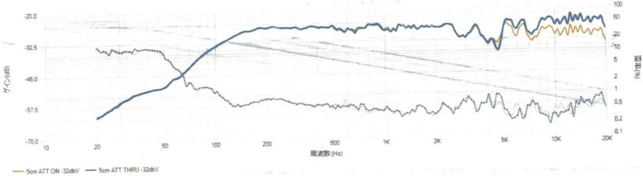
BOSE Acoustimass 5 音圧特性 測定距離 軸上80cm
