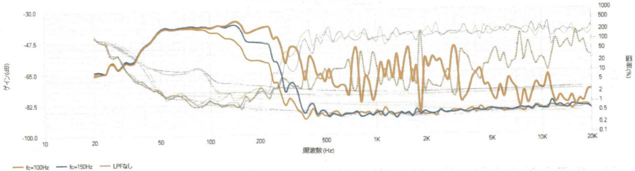
Pioneer S-X33C + Bose Acoustimass 5 合成音圧特性 Mic位置 S-X33C 軸上50cm
